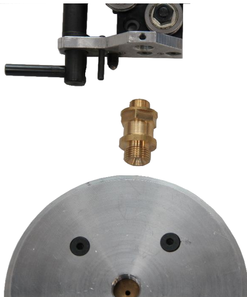
Adaptierung bei neuem Drahrichtwerk mit M14 Gewinde mit Adapter 9910 0000 54
