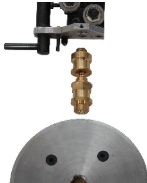
Adaptierung bei vorhandenen Drahrichtwerken mit 1/4" Gewinde mit den Adaptern 9910 0000 54 und 9910 0000 53
